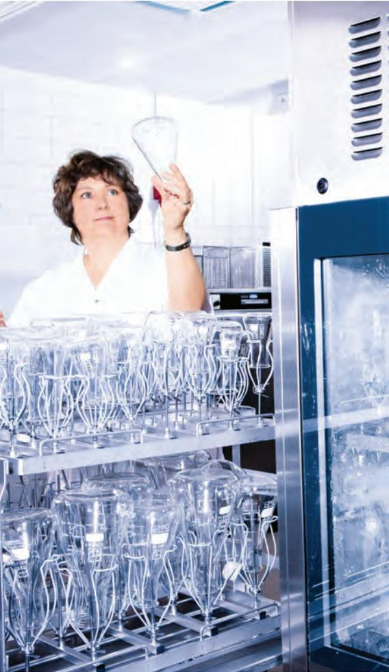
Visuelle Sichtkontrolle von Laborglas nach der maschinellen Aufbereitung
