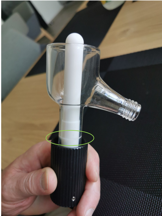
Ohne Nachstellen: Dichtring zeichnet sich kleiner auf dem Glas ab!
