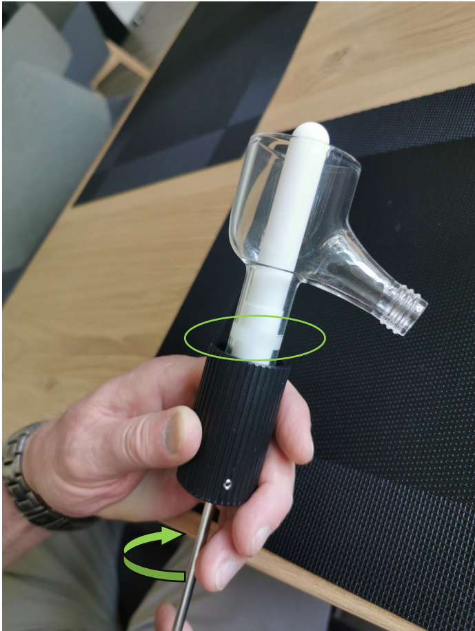
Nachstellen: Dichtring wird größer!
